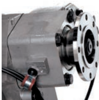
PRISE DE MOUVEMENT sur boîte de vitesses ou sur moteur pour faire fonctionner les équipements des carrossiers en roulant ou à l'arrêt.
