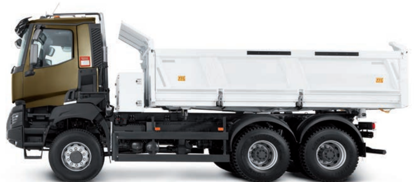
RENAULT TRUCKS K 6X6 avec fixations carrossier et prise de mouvement.
