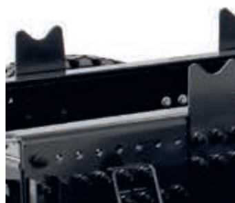
CORBEAUX PLAQUÉS SUR LONGERONS pour faciliter les opérations de carrossage.
