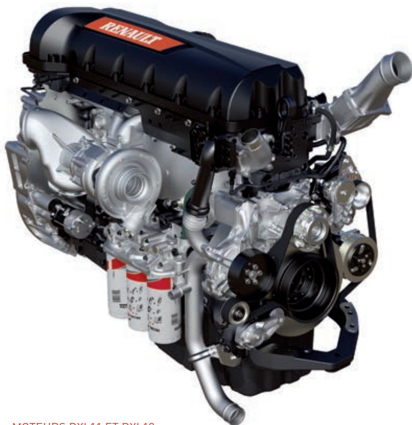
MOTEURS DXI 11 ET DXI 13 de 330 ch à 500 ch.
