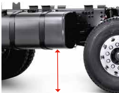
GARDE AU SOL SOUS RÉSERVOIR DE 440 MM*
