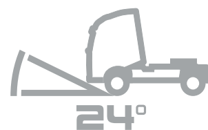
ANGLE D'ATTAQUE DE 24° POUR FRANCHIR LES OBSTACLES ET JUSQU'À 27° AVEC LE BOUCLIER ACIER
