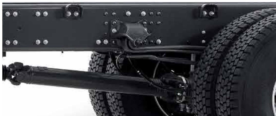
**LONGERONS CHÂSSIS DE 300 MM DE HAUTEUR ET DE 8 MM D'ÉPAISSEUR**
